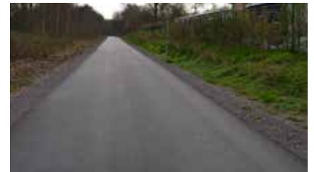
Kürzlich realisierte Radwege: Es fehlen Markierung und Beschilderung. Die Breite weicht um einige Dezimeter von der Mindestbreite der Qualitätsstandards ab.
