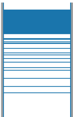
Anwendung einer Quermarkierung als aufmerksamkeitssteigerndes Element vor Konfliktbereichen und als Kennzeichnung von markanten Orten.
