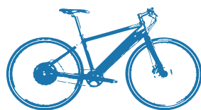
„Grace Easy“ Beispiel für ein S-Pedelec. Geschwindigkeit: max. 45km/h
